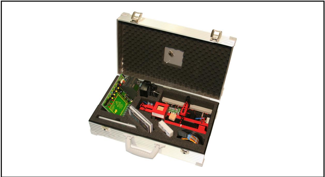
In einem handlichen und stabilen Aluminiumkoffer befindet sich übersichtlich und transportsicher ein Kompaktmodell Taktstraße mit 1 Maschine (Artikel-Nr. 226006), eine Kleinststeuerung Siemens LOGO! sowie ein Trainingsgerät LOGO!Learn\_Advanced, ein passendes Netzteil, Programmierkabel, –software und eine IR-Fernbedienung für die LOGO!Learn.
