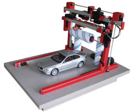
Die Firma Staudinger/Loiching bietet für die Ausbildung in Grafcet motivierende Modelle – hier eine Waschstrasse.
